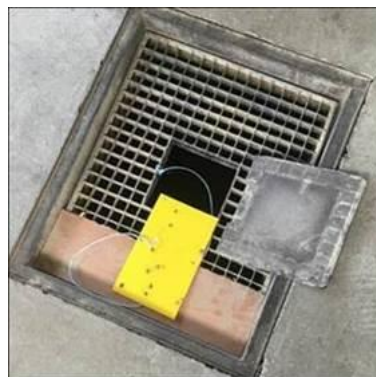
Mottenfang in der Silozelle
