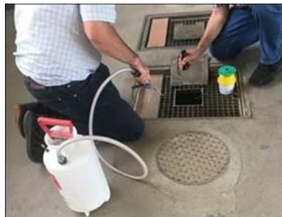
Leerraumbehandlung der Silozellen mit Kieselgur
